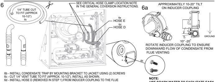
TAP IN THE CONDENSATE TRAP. 6e - INSTALL HOSE E FROM COLLECTOR BOX TO TOP OF CONDENSATE TRAP.
