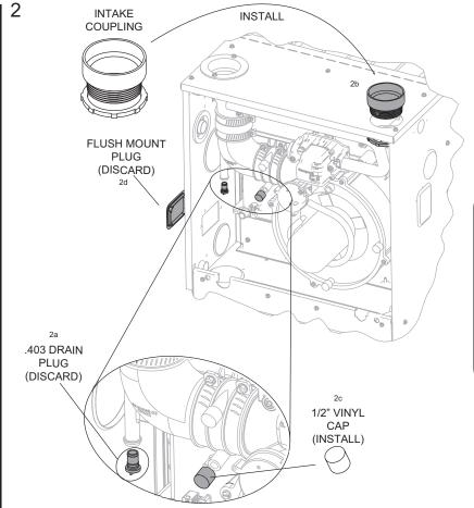
2a - REMOVE .403" DRAIN PLUG FROM FLUE ELBOW - DISCARD.
