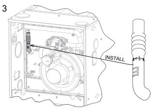
INSTALL HOSE E ON COLLECTOR BOX AS SHOWN. LET THE OPEN END HANG FREE UNTIL STEP 11.
