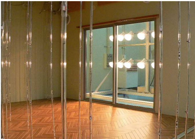
輻射パネル、日射装置などを組み合わせ 多様な室内環境を短時間で再現する室内側試験室
