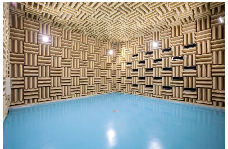
マイナス 25℃～50℃の外気温を再現する室外側試験室
