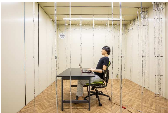
サーマルマネキンで人体各部の表面温度を測定しデータ化
