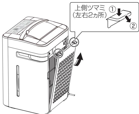
● 上側ツマミをはずして、矢印の方向に倒しながら上部に引き上げます。
