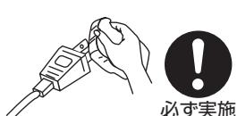
製品の移動の際は必ず電源プラグをコンセントから抜く
