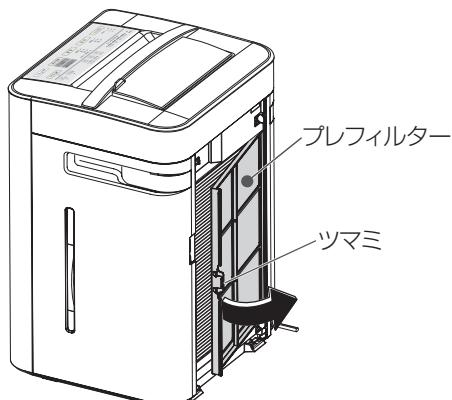
● ツマミを内側に押して、ロックを外し、矢印の方向に開くように取り外します。
