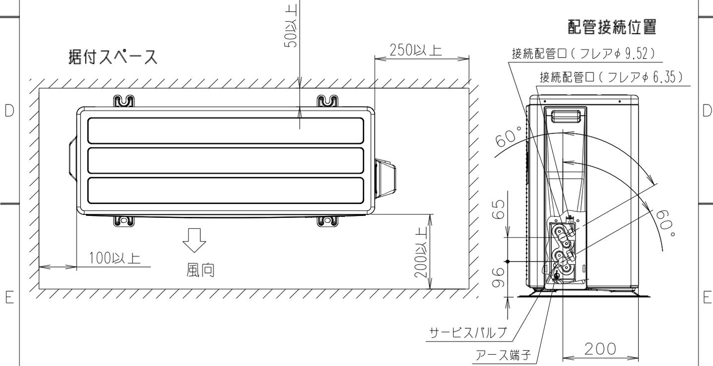
外形図及び据付寸法 (室外機)
