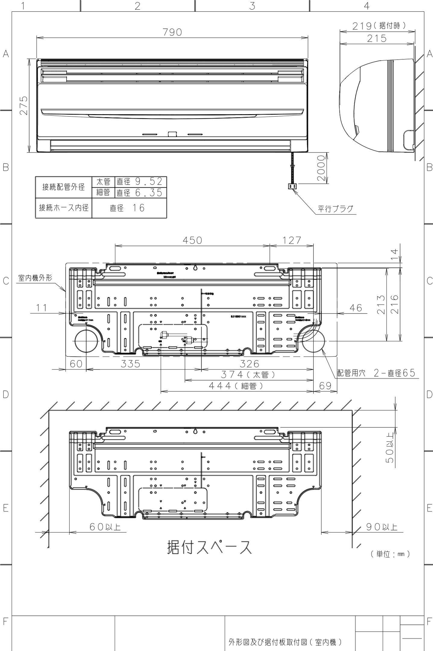
外形図及び据付板取付図(室内機)
