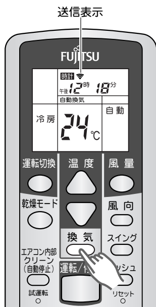
（例）冷房運転中に「自動換気」を選んだ場合
